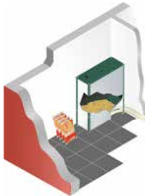
Pelletsbox 350 Liter mit Saugsonde manuell befüllbar
